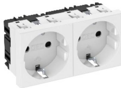
De protection prise de contact à double 0°, avec l'augmentation de la protection contre le toucher, avec bornes sans vis, 2 broches, 16 A, 250 V~, avec bornes de raccordement à la norme IEC 60884-1.
