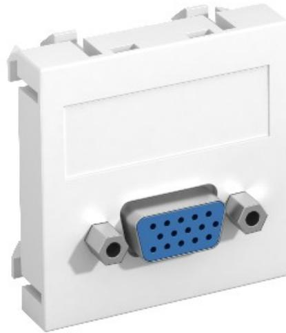
La prise en charge multimédia avec une connexion VGA prise, tout droit sortie de câble, avec l'étiquetage de bord, prise VGA (HD15) avec connexion à vis. Support de plaque avec verrouillage de la fixation, approprié pour l'installation horizontale et verticale dans l'environnement du système.
