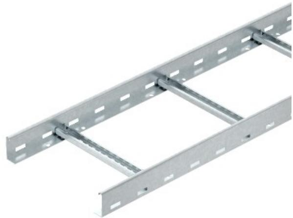
Kabel-Leiter mit 60-mm seitliche Höhe mit verschweißten C30-Profil-Sprossen, die offen sind, in einer Richtung nach oben. Gerollt Längsträger zur Verstärkung und als Kantenschutz. Die Befestigung der Halterung erfolgt mit Klemmen, Typ LKS 40. Die slot-dimension, der Rahmen ist 16,5 mm und den entsprechenden Klemme clip Typ 2056.
