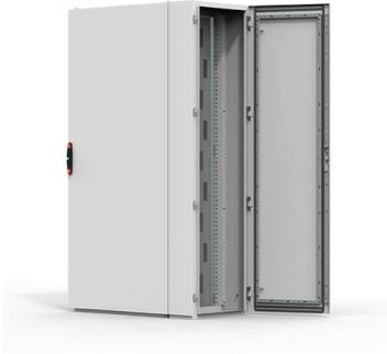
**Beschreibung:** 200 mm tiefer Aufsatz mit Kabeintrittsöffnungen auf der Ober- und Unterseite. Mit 1 Flansch und Dichtungsmaterial, gleiches Lochraster wie am Gehäuserahmen zur Befestigung von Kabelschienen. Eigener Türrahmen optional. Schutzart IP 33 & NEMA1 bei Einsatz MM Verbindungsplatte und Dichtung SPDG01. Türmontagerahmen als Zubehör.
