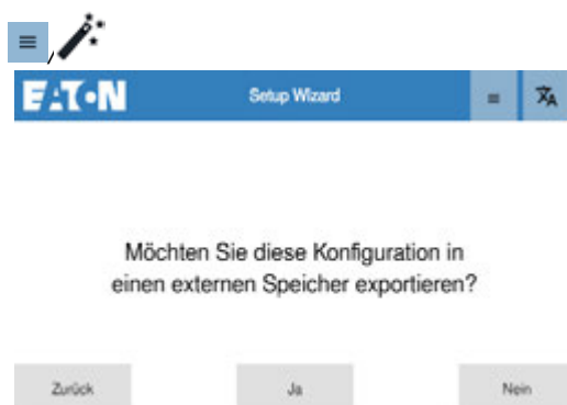
Abb. 42: Setup Schritt 6 - Setup-Konfiguration als *.rtd speichern
