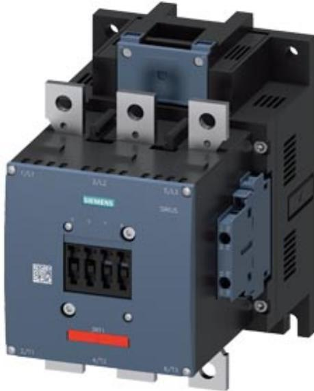
Leistungsschütz, AC-3 300 A, 160 kW / 400 V AC (50-60 Hz) / DC-Betätigung UC 110-127 V Hilfskontakte 2 NO + 2 NC 3-polig, Baugröße S10 Schienenanschlüsse Antrieb: konventionell Schraubanschluss Hilfsschalterblock 2 S + 2 Ö seitlich, links + rechts Hilfsschalterblock unlösbar DIN 50012
