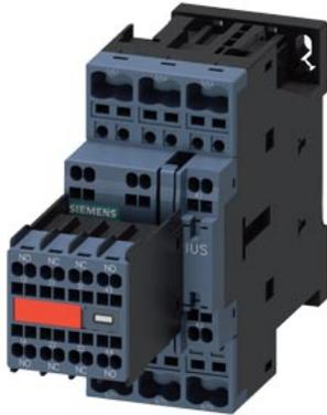
Leistungsschütz, AC-3 25 A, 11 kW / 400 V 2 S + 2 Ö, AC 230 V 50 / 60 Hz, 3-polig, Baugröße S0, Federzuganschluss Hilfsschalter nicht lösbar
