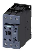
Leistungsschütz, AC-3 40 A, 18,5 kW / 400 V 1 S + 1 Ö, AC 600 V 60 Hz, 3-polig, Baugröße S2, Schraubanschluss
