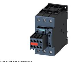
Koppelschütz, AC-3 40 A, 18,5 kW / 400 V 2 S + 2 Ö, DC 24 V mit Varistor, 3-polig, Baugröße S2, Schraubanschluss Hilfsschalter unlösbar geeignet für 2 A SPS-Ausgänge
