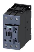
Leistungsschütz, AC-3 51 A, 22 kW / 400 V 1 S + 1 Ö, AC / DC 84-155 V, mit Varistor, 3-polig, Baugröße S2, Schraubanschluss
