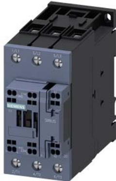
Leistungsschütz, AC-3 51 A, 22 kW / 400 V 1 S + 1 Ö, AC 110 V 50 / 60 Hz, 3-polig, Baugröße S2, Federzuganschluss
