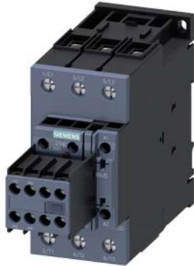
Leistungsschütz, AC-3 65 A, 30 kW / 400 V 2 S + 2 Ö, AC 230 V 50 Hz 3-polig, Baugröße S2 Schraubanschluss
