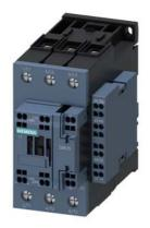
Schütz, AC-3, 37 kW / 400 V, 2 S + 2 Ö, AC 110 V, 50 Hz, 3-polig, Baugröße S2, Federzuganschluss seitlicher Hilfsschalterblock
