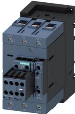
Leistungsschütz, AC-3 95 A, 45 kW / 400 V 2 S + 2 Ö, AC/DC 175-280 V 3-polig, 3S, Baugröße S3 Schraubanschluss Varistor integriert
