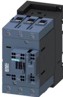
Leistungsschütz, AC-3 110 A, 55 kW / 400 V 1 S + 1 Ö, AC/DC 175-280 V
