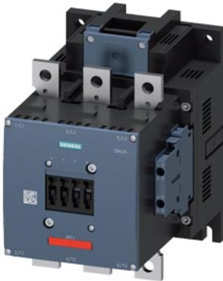
Contactor de potencia, AC-3 265 A, 132 kW/400 V AC (50-60 Hz)/mando por DC 110-127 V UC Bloque de contactos auxiliares 2 NA + 2 NC 3 polos, tamaño S10 conexiones de barras accionamiento: convencional conexión por tornillo bloque de contactos aux. 2 NA + 2 NC lateral, lado izquierdo + lado derecho bloque de contactos auxiliares no desmontable DIN 50012
