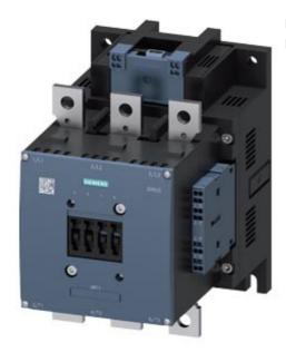
Contactor para ferrocarriles 1 AC, 500 A mando por DC 3 polos accionamiento electrónico con PLC-IN 24-110 V DC Us 110 V x (0,7-1,25) Bloques de contactos auxiliares 2 NA + 2 NC conexiones de barras Bloques de contactos auxiliares y conexiones de bobinas en bornes de resorte
