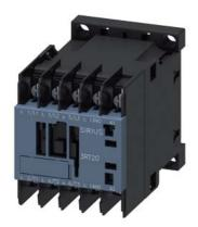
Contactor de potencia, AC-3 16 A, 7,5 kW/400 V 1 NA, 400 V AC, 50 Hz 400-440 V, 60 Hz, 3 polos tamaño S00 conexión por terminal de cable de ojal
