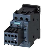
Contactor de potencia, AC-3 12 A, 5,5 kW/400 V 2 NA + 2 NC, 110 V AC, 50 Hz 3 polos, tamaño S0 conexión por tornillo Bloque de contactos auxiliares desmontable
