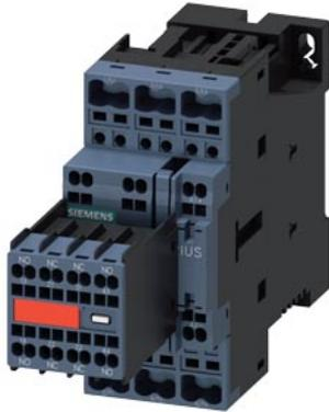
Contactor de potencia, AC-3 17 A, 7,5 kW/400 V 2 NA + 2 NC, 24 V DC, 3 polos, tamaño S0 conexión por resorte bloque de contactos auxiliares no desmontable
