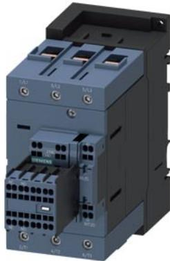
contactor para ferrocarriles, AC-3e/AC-3, 95 A, 45 kW/400 V, tripolar, 24 V DC, 0,7-1,25 \* US, accionamiento electrónico, con varistor integrado, contactos auxiliares: 2 NA + 2 NC, circuito principal: borne de tornillo, circuito de control y auxiliar: borne de resorte, tamaño: S3, bloque de contactos auxiliares desmontable
