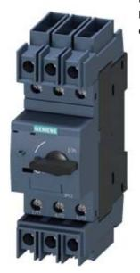
Interruptor automático tamaño S00 para protección de distribuciones con interruptor automático homologado UL 489, CSA C22.2 NO.5-02 Disparador por sobrecarga con retardo según intensidad 4 A Disparador de cortocircuito 52 A borne de tornillo poder de corte estándar
