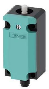
interruptor de posición Caja de plástico de 40 mm según DIN EN 50041 Conexión del aparato 1x (M20 x 1,5) 1NA/2NC contactos de acción brusca con conector M12, 4 polos 2NA conectados Asignación de pines: Pin1=21, Pin2=22 Pin3=31, Pin4=32 máximo 250 V y 4 A con vástago de teflón
