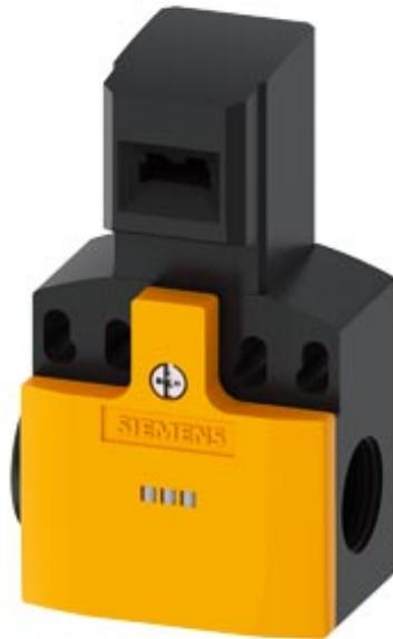
interruptor de posición de seguridad con actuador separado caja de plástico, 50 mm Conexión del aparato 2x (M20x 1,5) Contactos de acción normal 1NA+2NC con 2 LED en amarillo/verde 115-230 V AC 5 sentidos de ataque el correspondiente actuador separado 3SE5000-0AV0. debe pedirse por separado
