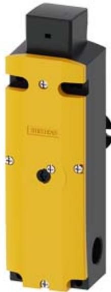
interruptor de posición de seguridad con retención Fuerza de retención 1300 N 5 sentidos de ataque Enclavado por resorte Desenclavamiento para escape detrás y desenclavamiento auxiliar delante Tensión en electroimán 115 V AC Vigilancia actuador 2NC/1NA Vigilancia electroimán 2NC/1NA Suministro sin actuador. Actuador 3SE5000-0AV0. debe pedirse por separado
