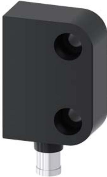
Interruptor magnético bloque de contactos, rectangular pequeño 26 x 36 mm, para tope de puerta izquierda, Contactos: Contactos de seguridad 2 NC, Contacto de señalización 1 NC, con 8 mm de conexión enganchable Conector 6 polos, sin LED, el correspondiente imán de conmutación 3SE6714-3CA o, girado 90°, 3SE6724-3CA
