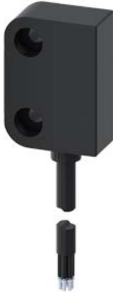
interruptor magnético bloque de contactos, rectangular pequeño 26 x 36 mm, para tope de puerta derecha, contactos: contactos de seguridad 2NC Contacto de señalización 1NC con 3 m de cable de conexión sin LED, la correspondiente Bobina de maniobra 3SE6714-3CA o con desplazamiento de 90° 3SE6724-3CA
