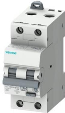
interruptor dif./aut., 10 kA, 2P tipo A, 30 mA, curva B, In: 20 A Un: 230 V i2 reducido  $i_2=1,3 \times I_n$
