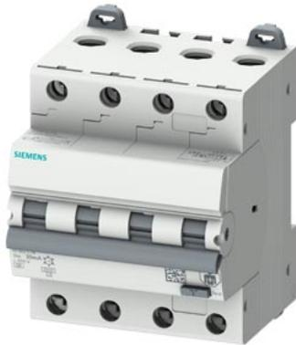
interruptor dif./aut., 6 kA, 4P tipo A, 30 mA, curva B, In: 32 A Un: 400 V
