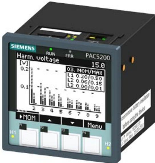
SETRON, instrumento de medida y registrador de la calidad de la energía, 7KM PAC5200, LCD, L-L: 690 V, L-N: 400 V, 10 A, 3 fases, Modbus TCP, Energía aparente / activa / reactiva /cos phi, armónicos: 2.º-40.º, THD, clase 0,5 según IEC61557-12 o bien clase 0,5S según IEC62053-22, fuente de alimentación universal, AC/DC, borne de tornillo
