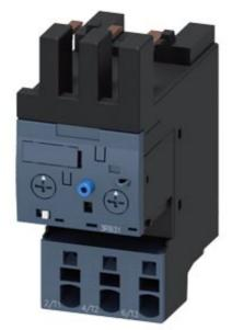
Relais de surcharge 1...4 A électronique pour protection des moteurs taille S0, CLASS 5...30 Montage sur contacteur circuit principal : bornes à ressort circuit auxiliaire : bornes à ressort Réarment automatique/manuel Détection interne des défauts à la terre
