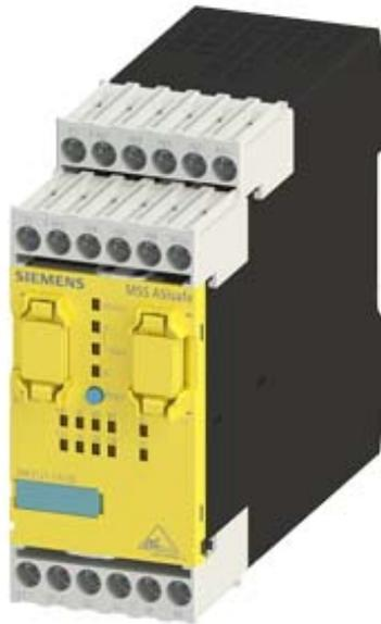
SIRIUS, Module central 3RK3 ASIsafe Basic pour système de sécurité modulaire 3RK3 1/2F-DI,6DI,1F-RO,1F-DO,24V CC Moniteurs d'esclaves AS-i Commande de 8 sorties de sécurité sur le bus AS-Interface paramétrable avec logiciel Safety ES largeur 45mm borne à vis jusqu'à SIL3 (CEI 61508) jusqu'au niveau de performance E (ISO 13849-1) aucun module d'extension raccordable
