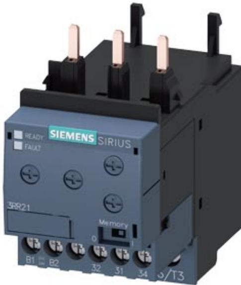
Relais de surveillance, pouvant être monté sur contacteur 3RT2, Taille S0 Basic, à réglage analogique surveillance de courant apparent 4...40 A, 50...60 Hz, biphasé Alimentation 24 V CA/CC 1 contact inverseur Surveillance de dépassement haut/bas du courant Perte de phase, rupture de fil avec ou sans mémoire défaut Temporisation au démarrage 0-60 s Suppression des pointes de perturbation 0-30 s Hystérésis de commutation 6 % Connectique par bornes à vis
