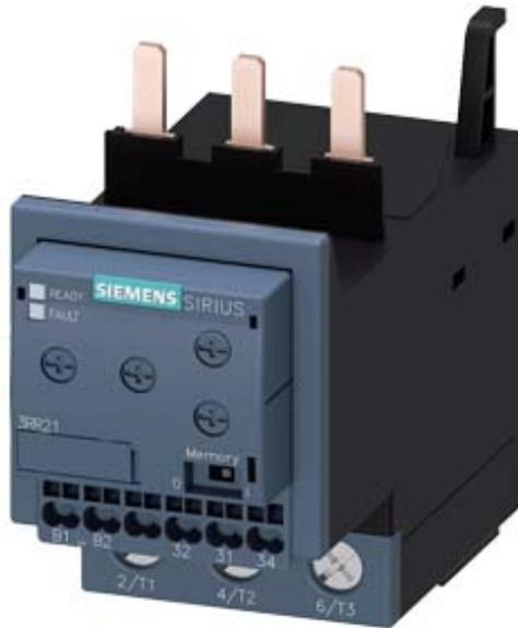
Relais de surveillance, pouvant être monté sur contacteur 3RT2, Taille S2 Basic, à réglage analogique surveillance de courant apparent 8...80 A, 50...60 Hz, biphasé Alimentation 24 V CA/CC 1 contact inverseur Surveillance de dépassement haut/bas du courant Perte de phase, rupture de fil avec ou sans mémoire défaut Temporisation au démarrage 0-60 s Suppression des pointes de perturbation 0-30 s Hystérésis de commutation 6 % Connectique par bornes à ressort
