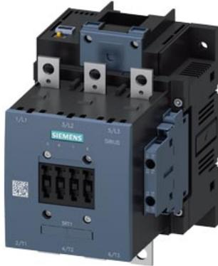
contacteur de puissance, AC-3e/AC-3 115 A, 55 kW / 400 V, U<sub>c</sub> : DC 110 V x (0,7-1,25) entrée API 24-110 V DC 3 pôles, contacts auxiliaires 2 NO + 2 NF
