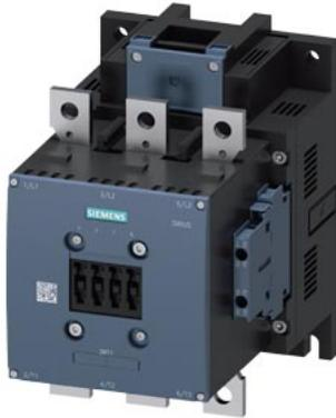
Contacteur, 1 CA, 500 A/690 V/40 °C, S10, 3 pôles, 110-127V CA/CC, avec varistance, 2 NO +2 NF, barre de raccordement/ borne à vis
