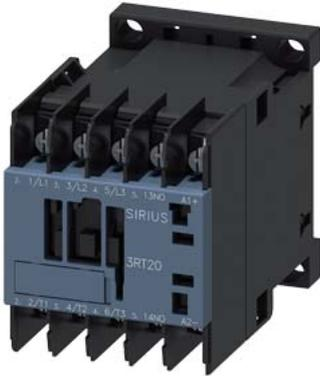
Contacteur de puissance, AC-3 16 A, 7,5 kW / 400 V 1 NO, 24V CC 3 pôles, taille S00 Connexion par cosse à œillet
