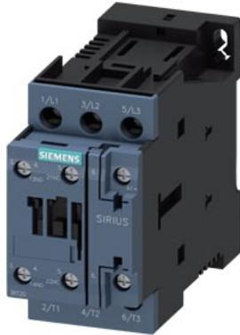
Contacteur ferroviaire, AC-3 9 A, 4 kW / 400 V 1 NO + 1 NF avec commande électronique 110 V CC, 0,7-1,25\* US avec varistance intégrée 3 pôles, taille S0 borne à vis
