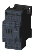
Contacteur de puissance, AC-3 : 9 A, 4 kW / 400 V 1 NO + 1 NF, AC 24 V, 50/60 Hz 3 pôles, Taille S0 borne à ressort circuit RC 3RT2916-1CC00 intégré
