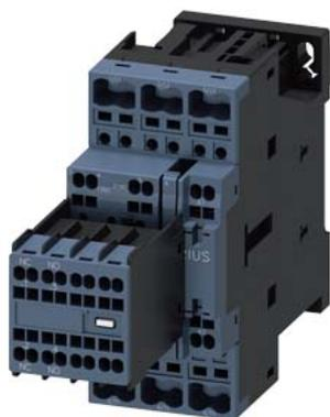
Contacteur de puissance, AC-3 : 12 A, 5,5 kW / 400 V 2 NO + 2 NF, AC 400 V, 50Hz 3 pôles, Taille S0 borne à ressort Interrupteur auxiliaire amovible
