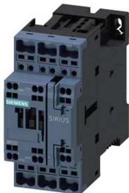
Contacteur de puissance, AC-3 : 12 A, 5,5 kW / 400 V 1 NO + 1 NF, 24 V CC 3 pôles, Taille S0 borne à ressort
