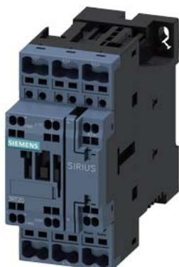
Contacteur de puissance, AC-3 : 12 A, 5,5 kW / 400 V 1 NO + 1 NF, CA (50-60 Hz) circuit de commande DC 200-280 V CA / CC 3 pôles, Taille S0 borne à ressort
