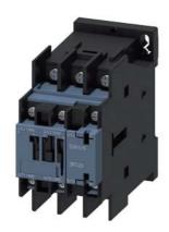
Contacteur de puissance, AC-3 : 17 A, 7,5 kW / 400 V 1 NO + 1 NF, AC 400 V, 50 Hz, 400-440 V, 60 Hz, 3 pôles, Taille S0, Connexion par cosse à ceillet
