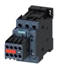
Contacteur de puissance, AC-3 25 A, 11 kW / 400 V, 2 NO + 2 NF, 24V CC, avec varistance enfichée 3 pôles, taille S0 borne à vis Interrupteur auxiliaire non amovible
