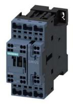
Contacteur de puissance, AC-3 : 25A, 11 kW / 400 V 1 NO + 1 NF, DC 110 V 3 pôles, Taille S0 borne à ressort
