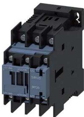
contacteur de puissance, AC-3 25 A, 11 kW / 400 V, 1 NO + 1 NF 24 V CC, CC 0,7-1,25\* US, à varistance intégrée 3 pôles, taille S0 connexion par cosse à œillet convient pour sorties API pas extensible avec un contact auxiliaire
