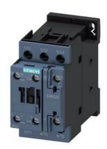
contacteur, version NEMA, 10 HP, 460 / 575 V, 3 pôles, AC 110 V, 50 Hz / 120 V, 60 Hz, contacts auxiliaires : 1 NO + 1 NF, borne à vis, taille : S0
