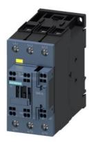
contacteur de puissance, AC-3e/AC-3, 41 A, 18,5 kW / 400 V, 3 pôles, 21-33 V CA / CC, 50/60 Hz, avec varistance intégrée, contacts auxiliaires : 1 NF, circuit principal : borne à vis, circuit de commande et de courant auxiliaire : borne à ressort, taille : S2, F-PLC-IN
