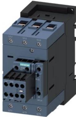
Contacteur de puissance, AC-3 : 80A, 37 kW / 400 V 2 NO + 2 NF, 220 V CA/50 Hz 240 V/60 Hz 3 pôles, 3S, Taille S3 borne à vis
