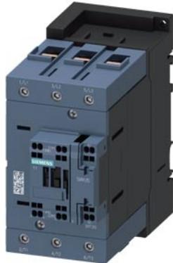
Contacteur de puissance, AC-3 : 80A, 37 kW / 400 V 1 NO + 1 NF, 208 V CA / 50/60 Hz 3 pôles, 3S, Taille S3 borne à ressort
